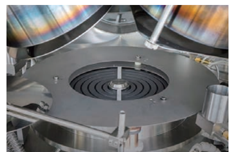
基板加熱ヒーター(SiCコート)
